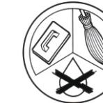
Основата трябва да бъде гладка, чиста и суха. Основата може да бъде подгответа (подравнена) чрез изрязване на балонираните повърхности и запълването им с битумен мастик. За по-добра адхезия се препоръчва допълнителна обработка с битумен грунд.
